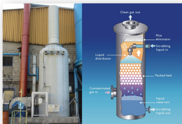
Vista instal·lació scrubber i esquema funcionament
